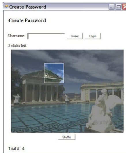
Abbildung 3.7: Die Benutzeroberfläche von PCCP. Der Nutzer wird dazu aufgefordert seinen Klickpunkt innerhalb des heller dargestellten Sichtfensters zu setzen. Mittels des Shuffle Knopfes wird das Sichtfenster an einer neuen zufälligen Position erzeugt. [7]
